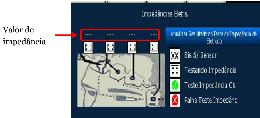
Fig. 10-5 Janela de resultados do teste de impedância do eletrodo
